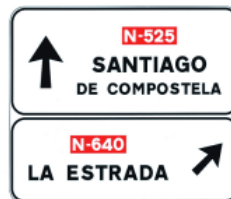
S-220 Preseñalización de direcciones hacia una carretera convencional
