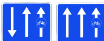
S-64 Carril bici o vía ciclista adosada a la calzada
