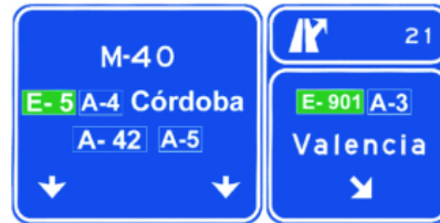
S-368 Señales sobre la calzada, en autopista o autovía. Salida hacia autopista o autovía y dirección propia
