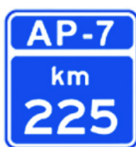
S-570a Hito kilométrico en autopista de peaje
